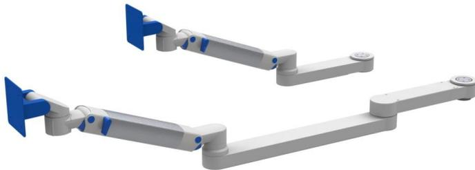
Les câbles électriques requis passent dans les éléments et dans les articulations. Il y a suffisamment d'espace pour introduire au moins 4 câbles et un fil de terre (une utilisation normale requiert 1x câble d'alimentation, 1x fil de terre et 1x câble vidéo). Le nombre de câbles qu'il est possible d'insérer dépend principalement de leur diamètre.
